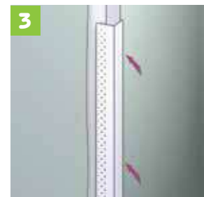
3 Se aplică un strat subțire de ipsos de îmbinări și se lipește banda cu fața către colț
